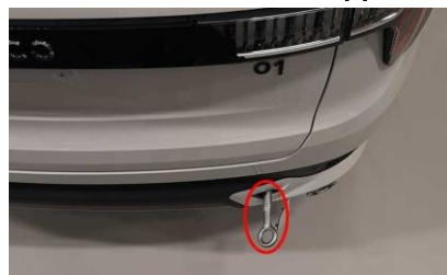
Position hinterer Abschlepphaken
