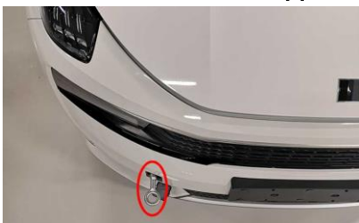
Position vorderer Abschlepphaken
